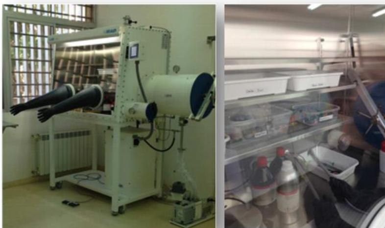
**Figura 2.5:** Cámara hermética con atmósfera controlada de argón y concentraciones de oxígeno e hidrógeno menores a 0,5 ppm. Marca MB10 compact, MBraun.
